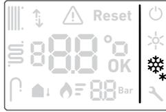
Si en lugar de ascender, la temperatura del agua baja, al llegar a los 5 °C, la caldera se enciende hasta llegar a los 30 °C. De esta manera se evitan fenómenos de congelamiento en el circuito de calefacción.
