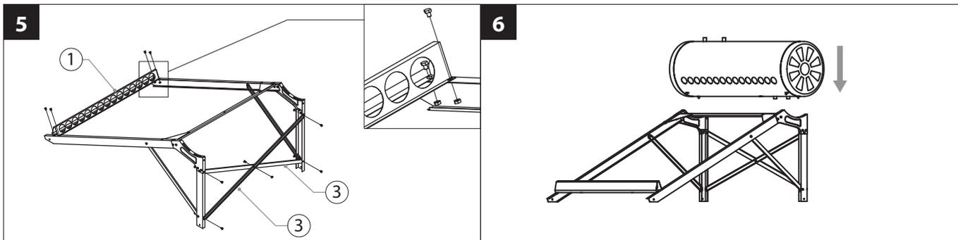
Antes de avanzar al siguiente paso, realice las conexiones de entrada de agua y salida de agua caliente del tanque.
