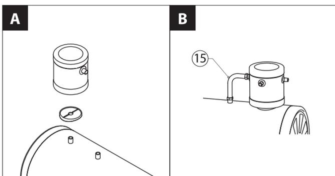
**INSTALACIÓN CON TANQUE DE PRE LLENADO**
