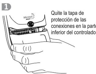
Quite la tapa de protección de las conexiones en la parte inferior del controlador;
