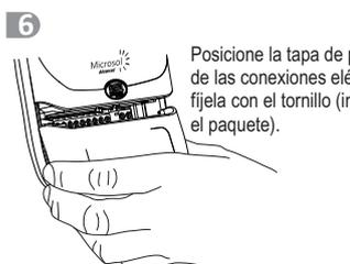
Posicione la tapa de protección de las conexiones eléctricas y fíjela con el tornillo (incluido en el paquete).
