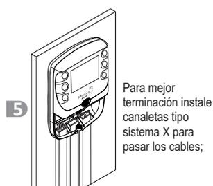
Para mejor terminación instale canales tipo sistema X para pasar los cables;
